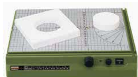
Pre okrúhle výrezy existuje jednoduché riešenie. Pripínáčik upevnený obojstranne lepiacou páskou prilepte na pracovný stôl a získate tým stabilnú os predmetu, ktorý chcete vyrezávať do kruhu.
